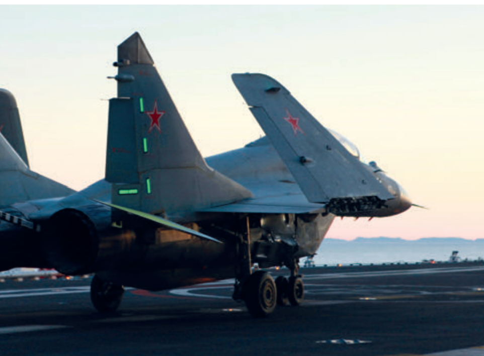
Момент касания палубы с одновременным зацепом за трос аэрофинишера, 10 сентября 2013 г.
